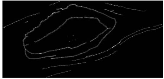
Figura 3. Sito 10. Rilievo base realizzato con stazione totale e lavorato in CAD.
