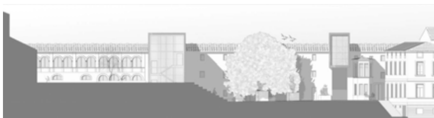
Fig. 12. Prospetto interno, dove è visibile la scelta progettuale del taglio e quella dell'addizione
