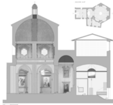
Fig. 13. Sezione Chiesa. Stato di fatto
