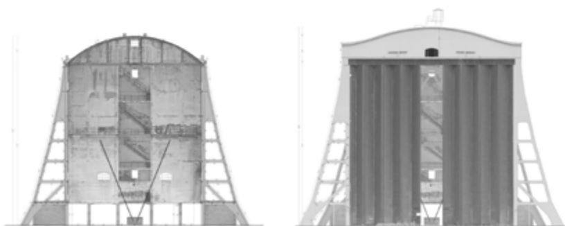
Fig. 8. Sezione trasversale e Prospetto sud (rilievo)
