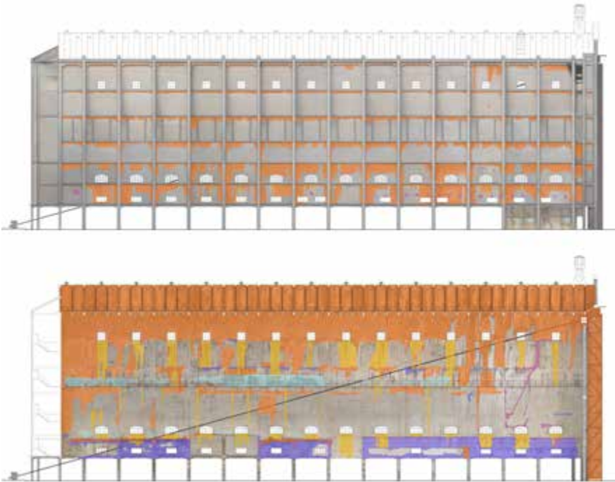
Fig. 10. Analisi delle patologie di degrado prospetti interni longitudinali
