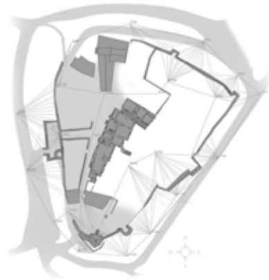
Fig. 4. Mappa di schematizzazione del processo di rilievo celerimetrico dai vertici di stazione verso le parti della struttura
