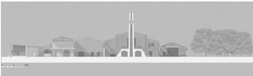
Fig. 8. Sezione trasversale (est-ovest) passante per il forno Hoffmann con fotopiano materico ed ombre a 45 gradi
