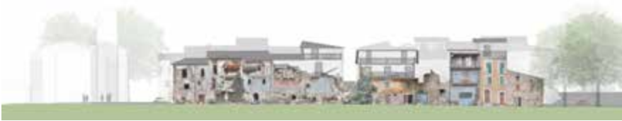
Fig. 7. Prospetto sud. Sovrapposizione post sisma/ricostruzione 3d ante sisma
