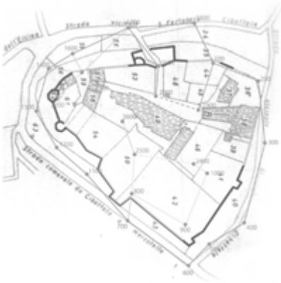
Fig. 3. Progetto della Poligonale per il rilievo delle mura del castello di Cibottola
