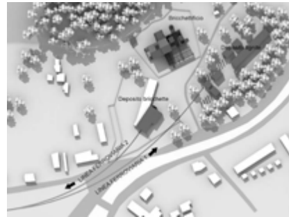
Fig. 4. Planimetria generale della zona con ricostruzione dei depositi e del percorso ferroviario. La linea 1 portava il materiale grezzo nel deposito di lignite (attualmente distrutto), da qui trasportato nell'area di stoccaggio quindi all'interno della fabbrica dove entrava nel ciclo di produzione. Il prodotto finito (bricchette) veniva depositato in un secondo edificio (attualmente esistente) e portato via lungo la linea 2
